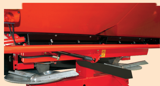
Механическая заслонка для одностороннего разбрасывания
