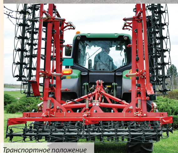
Усиленные S-стойки с „гусиными лапками“
