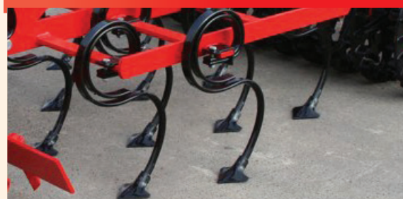
Усиленные S-стойки с „гусиными лапками“
